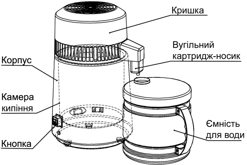
Малюнок 1 – Зовнішній вигляд та головні вузли дистильатора.
